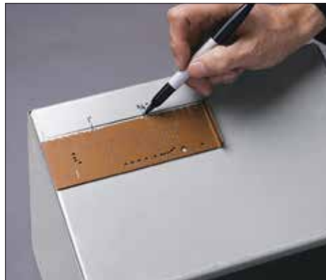
STEP 2 MARK CONDUIT COMBINATION
