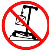
Utiliser seulement sur une surface dure et de niveau. Dégager la zone de travail des objets en désordre et des débris.
