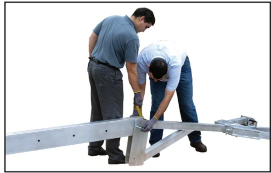
4. Levante el extremo de la viga transversal sin ningún perno insertado y colóquelo en el soporte con forma de A alineándolo con el agujero del perno en el soporte con forma de A con el agujero del perno que desee en la viga transversal.
