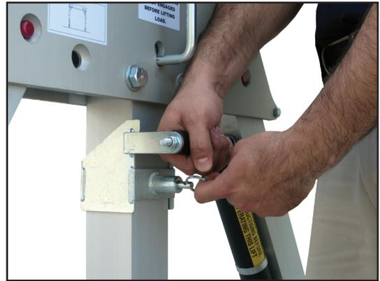
Suelte el posicionador de muelle en la manivela elevadora y deslice la manivela a la posición deseada que sea más adecuada para elevar o bajar la altura del soporte. Suelte el posicionador de muelle y asegúrese de que se bloquea en la posición deseada con los agujeros preestablecidos antes de intentar ajustar la altura.
