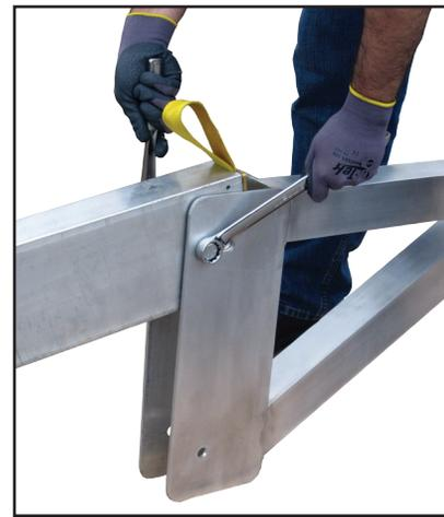
5. Coloque el perno en el orificio del soporte con forma de A y atraviéselo con arandelas en cualquiera de los lados del perno. Apriete levemente para que el soporte pueda girar cuando se levante.
