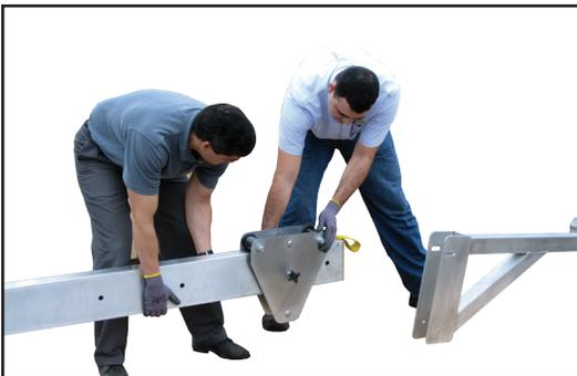
3. Coloque el carrito en el extremo opuesto de la viga transversal. Centre el carrito en la viga transversal y ajuste con un tornillo de fijación.
