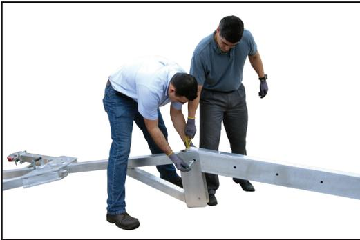
2. Levante un lado de la viga transversal sobre el soporte con forma de A y alinee el agujero exterior del perno en el soporte con forma de A con el agujero del perno que desee en la viga transversal. Coloque el perno en el orificio del soporte con forma de A y la viga transversal con arandelas en cualquiera de los lados del perno. Apriete levemente para que el soporte pueda girar cuando se levante.
