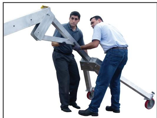
6. Eleve uno de los soportes con forma de A y alinéelo dentro del agujero del perno en el soporte con el agujero del perno correspondiente en la viga transversal. Use una escalera para colocar el perno en su agujero en el soporte con forma de A y la viga transversal. Apriete ambos equipos de pernos.
