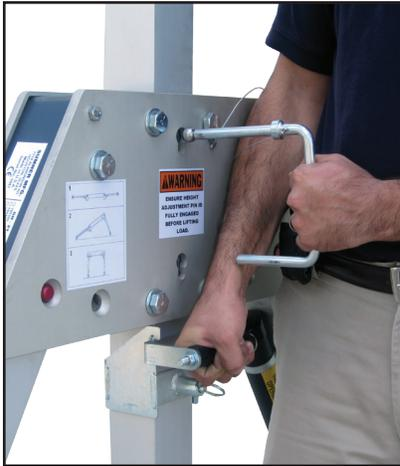
2. Una vez que se ha quitado la clavija de bloqueo, eleve o baje el soporte a la altura deseada. Vuelva a poner la clavija de bloqueo.
