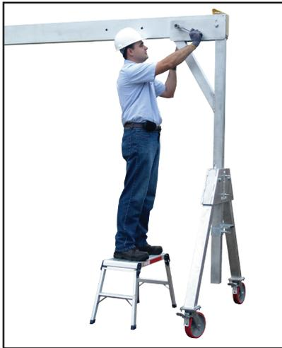
7. Eleve el segundo soporte con forma de A y alinéelo dentro del agujero del perno en el soporte con el agujero del perno correspondiente en la viga transversal. Coloque el perno en el orificio del soporte con forma de A y la viga transversal con arandelas en cualquiera de los lados del perno. Apriete por completo ambos equipos de pernos.
