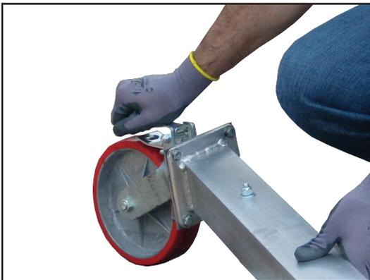
3. Bloquee las ruedas de ambos soportes presionando el mecanismo de freno de estas.
