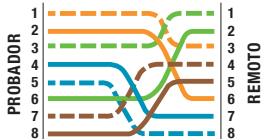
T568B Cable de Datos Cruzado Conectado Correctamente
