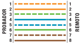
T568B Cable de Datos Cruzado Conectado Correctamente
