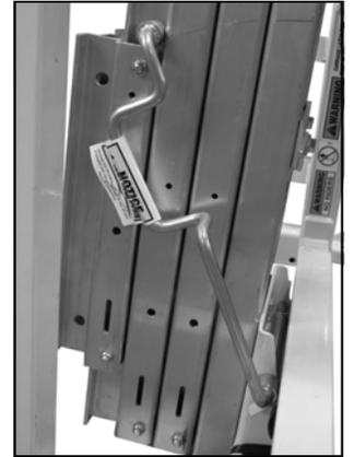
El ascensor se ha enviado con la retención del mástil Down Bar comprometidos. El propósito de la retención del mástil hacia abajo, es mantener las secciones del mástil se extienda durante el transporte. Para utilizar el ascensor, tirar barra hacia usted y coloque detrás del mástil.
