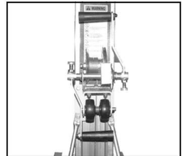
Para colocar las manivelas removibles en la posición funcional, tire del pasador de enclavamiento y deslice la manivela del eje del malacate. Haga girar el ensamblaje de la manivela de tal forma que el mango de plástico negro quede orientado en sentido opuesto al malacate. Mientras tira del pasador de enclavamiento, deslice la manivela de regreso en el eje del malacate. Repita este procedimiento para la otra manivela.
