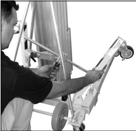
Para volver a colocar la pierna en posición replegada, apriete el mecanismo de liberación de bloqueo y doble la pierna.
