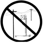
Evite y esté pendiente siempre de cables y obstrucciones sobre la cabeza cuando use la unidad o la traslada de y hacia el sitio de trabajo.
