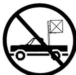
Si una unidad tiene una carga levantada, solamente se podría trasladar en las ruedas sueltas de 5 pulgadas (12.5 cm). Nunca use la unidad en una superficie inestable, como la plataforma de un camión.
