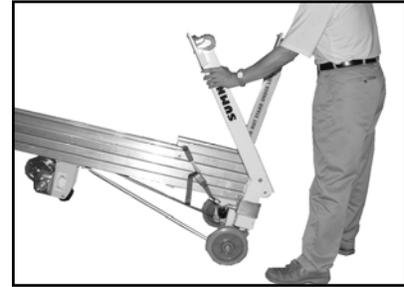
Mientras sostiene la pata en la posición de 90 grados, deslice el cerrojo de la pata hacia atrás de la misma, hasta que el pasador activado con resorte enganche en su posición.
