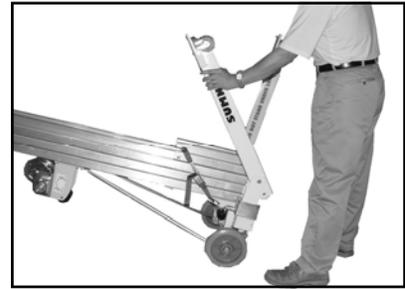
脚を 90 度の角度に保ちながら、脚ロックを脚側に戻し、スプリング内蔵ピンが元の位置に収まるようにします。
