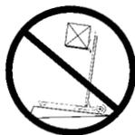
必ず水平な地面上で操作してください。リフトが転倒したり、作業員が怪我することがないように、リフトは必ず水平な地面上で操作してください。
