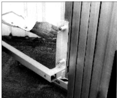
スプリング内蔵ピン 2 本を外します。フォークアセンブリーを 180 度回転させます。スプリング内蔵ピン 2 本をセットします。
