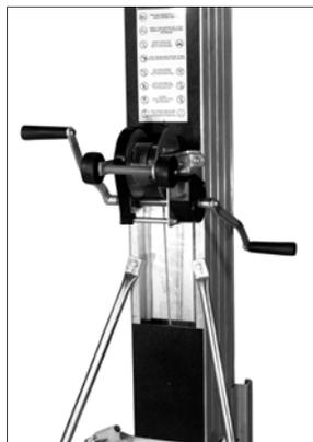
ウインチをクランクで操作し、必要な位置までフォークを上下させます。次にウインチハンドルを 1/4 回転ほど持ち上げ、安全ブレーキをセットします。
