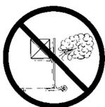
強風時にリフトを使用しないでください。強風時にかさばる荷を持ち上げると、風の影響で転倒したり、作業員が怪我をする場合があります。
