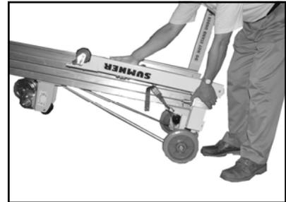
収納時に脚を戻す際は、固定ロックレバーを押し、ロックを解除し、脚を折りたたんでください。
