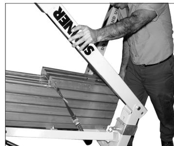
Enquanto estiver segurando a sapata na posição de 90 graus, deslize a Trava da Sapata de volta no sentido da sapata até que o pino do êmbolo acionado por mola engraze na posição.
