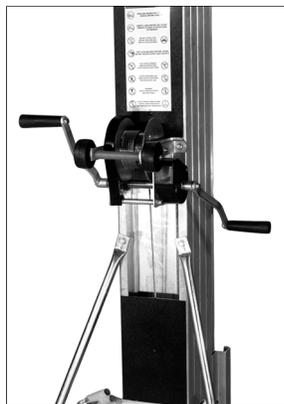
Use o guincho para acionar os garfos para cima ou para baixo para a posição desejada. Em seguida acione os punhos do guincho para cima cerca de 1/4 volta para acionar o freio de segurança.
