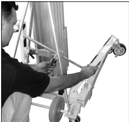
Para substituir a perna na posição retraída, aperte a liberação de mecanismo de bloqueio e dobrar a perna para cima.
