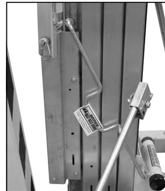
Para soltar a Retenção, puxe a barra na sua direção e coloque de volta atrás das seções do mastro.
