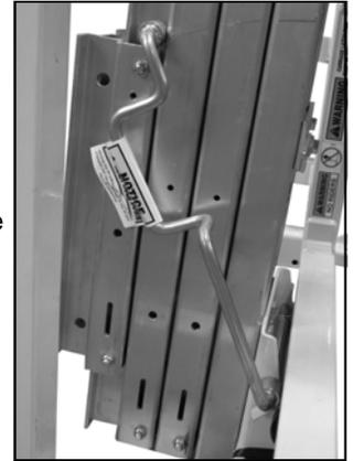
Der Aufzug wird mit dem eingerasteten Mast-Niederhaltebügel ausgeliefert. Dieser Mast soll ein Ausdehnen der Mastabschnitte während des Transports verhindern. Machen Sie zur Inbetriebnahme Ihres Aufzuges die Sicherheitsverriegelung los und entfernen Sie die Plastikverpackung, die an der Aufzugsplattform befestigt ist.
