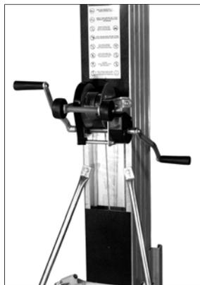
Benutzen Sie die Kurbel, um die Gabeln in die gewünschte Position hoch- oder herunterzukurbeln. Kurbeln Sie dann die Kurbelgriffe ca. um eine Viertelumdrehung nach oben, um die Sicherheitsbremse einzustellen.
