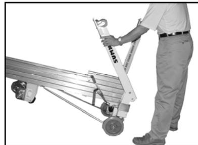
Indem Sie den Stab in einer 90° Position halten, schieben Sie die Stabverriegelung zurück in Richtung des Stabes, bis der Federdruckraststift einrastet.
