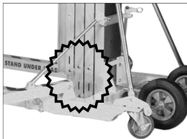
Para soltar o freio, coloque o elevador de volta sobre as rodas do guincho e coloque a ferramenta na ranhura de acesso ao freio localizada no lado esquerdo do elevador e através do orifício no contrapeso.
