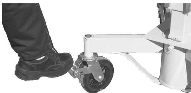
1. Acione o freio pressionando para baixo a alavanca do freio conforme mostrado.
