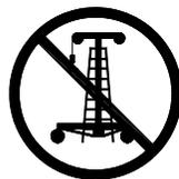
Não suba ba Roust-A-Bout ou coloque carga lateral no mastro.
