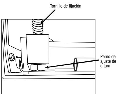
Presionar hacia abajo el brazo del rodillo para comprobar si la altura es correcta
