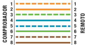
T568B Cable de Datos Cruzado Conectado Correctamente
