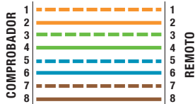
T568B Cable de Datos con Par con Corto y Par Abierto
