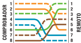
T568B Cable de Datos con Pares Divididos
