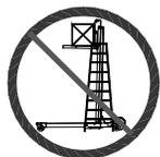
Não suba no mastro ou coloque uma carga lateral no mastro. Não use para apoiar escadas para subida ou içamento.
