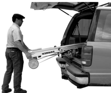
Para carregar o elevador em um caminhão ou furgão, incline o elevador para trás na lateral do guincho até que as rodas de 3" entrem em contato com o fundo do caminhão. Levante a extremidade inferior do elevador e role a unidade para a posição.
