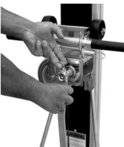
Para inverter o punho do guincho, puxe o pino acionado por mola com uma mão deslizando ao mesmo tempo o punho para fora com a outra mão. Gire o punho 180° e reinstale. Isso coloca o punho do guincho em um local seguro para transporte ou guarda.
