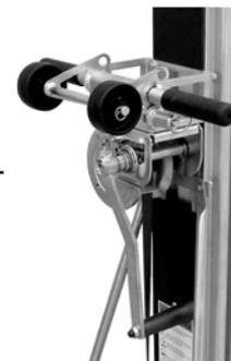
A Trava de Segurança do Carro pode ser engrazada tanto para o carro ou para os garfos. Ao engrazar nos garfos, arrie totalmente o carro para baixo. Prenda o Encaixe de Segurança na Alça da Trava de Segurança no lado do Conjunto do Garfo.
